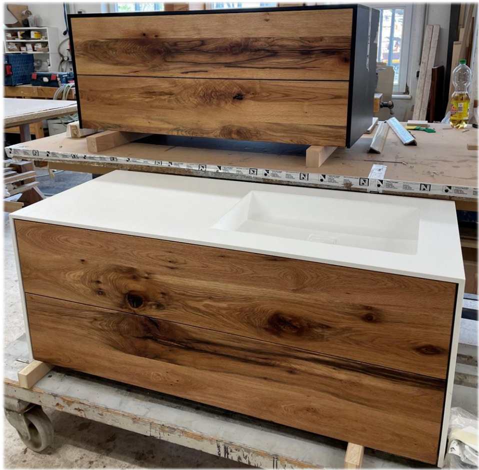
Waschtisch-Modell 2 mit Altholz Front: 1) schwarz matte Umrandung in HPL 2) weiße Umrandung inkl. fugenlos eingelassenem Becken in Mineralwerkstoff
